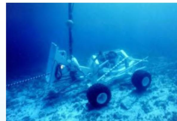
*ROV Hydroplow adatto a compiti installativi del cavo
