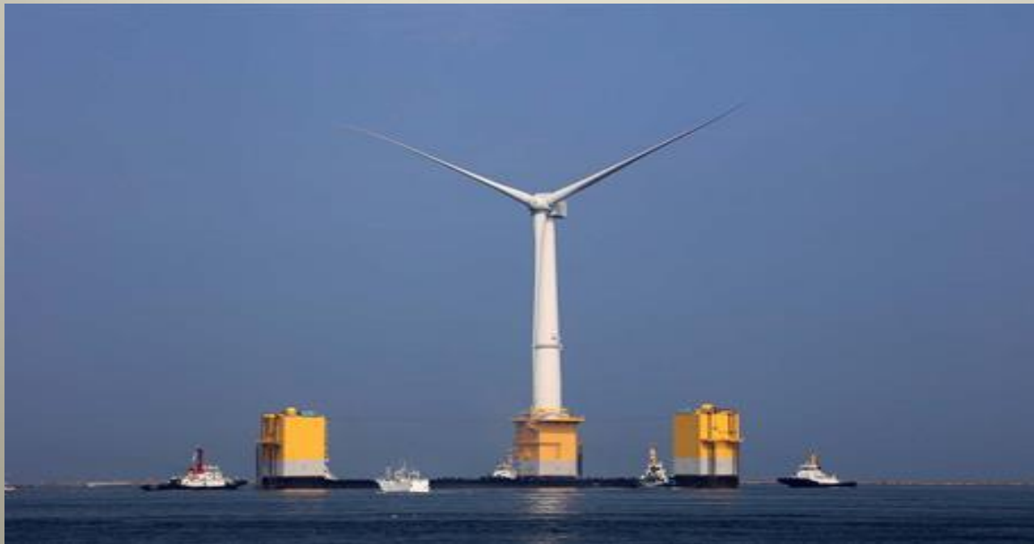
Fig.9 Prototipo eolico galleggiante Mitsubishi da 7 MW (fonte: http://www.fukushima-forward.jp )
